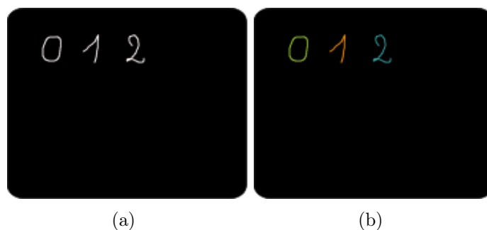
FIGURE 2.5 – Résultat de l’application de l’étiquetage de région. (a) image binarisée ; (b) image étiquetée.
