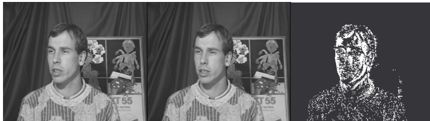
FIG. 5 – DEUX IMAGES CONSECUTIVES D'ERIK (A ET B) ET L'ESTIMATION DU FLOT OPTIQUE
