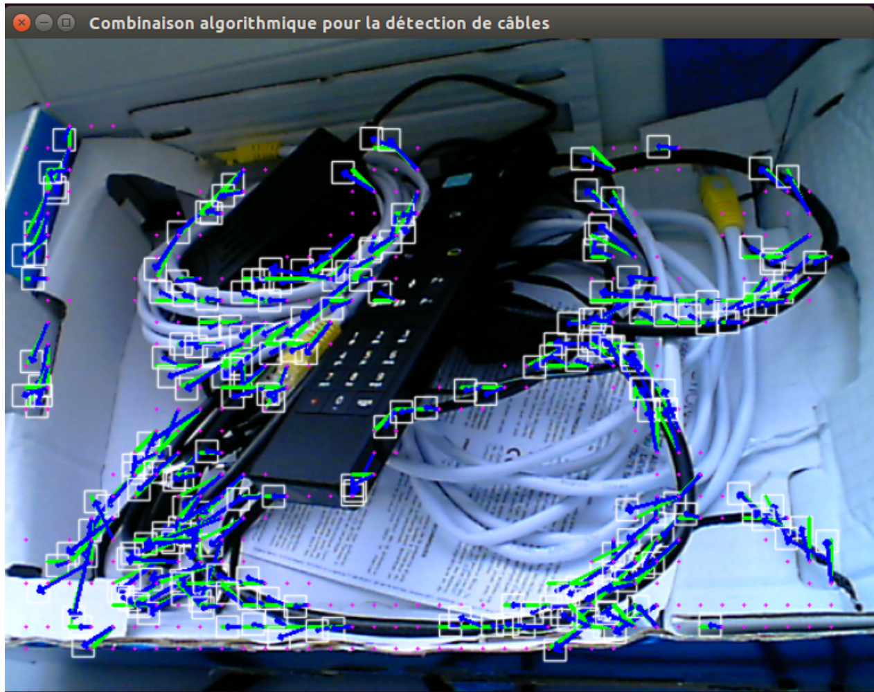
FIGURE 50 – On réalise les orientations locales avec poids sur les câbles, on valide les vecteurs qui sont référencés par d'autres (conservation d'une suite logique de points) puis on les relie. Plus tard, on éliminera les bords de carton avec la méthode de Hough (détection de lignes) puis on essaiera de réaliser une interpolation des points de vecteurs (trouver une courbe). Les résultats sont moyens pour les câbles blancs (faute du gradient).
