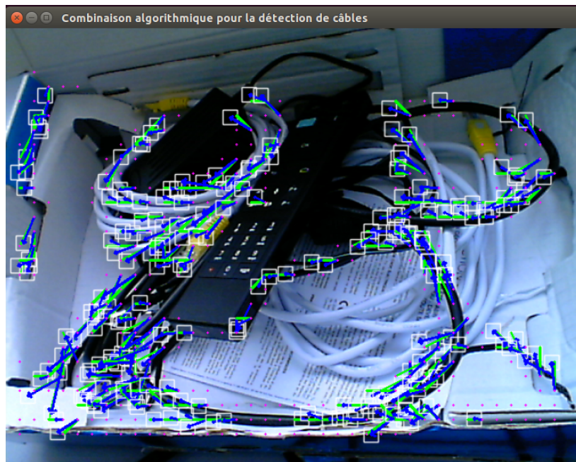
FIGURE 11 – On réalise les orientations locales avec poids sur les câbles, on valide les vecteurs qui sont référencés par d'autres (conservation d'une suite logique de points) puis on les relie. Plus tard, on éliminera les bords de carton avec la méthode de Hough (détection de lignes) puis on essaiera de réaliser une interpolation des points de vecteurs (trouver une courbe).
