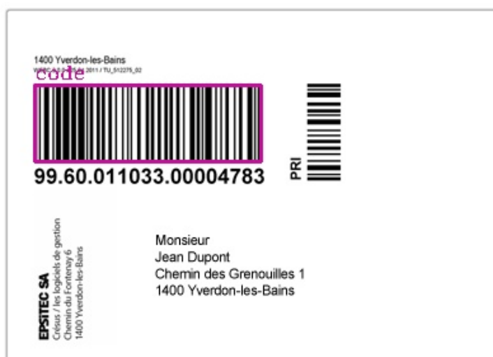
FIGURE 64 – Exemples de résultat d’une approche détection de code barre basée sur l’étude d’un modèle de lignes parallèles et ordonnées sur des critères d’espacements relatifs. Non retenue car peu efficace et trop sensible.
