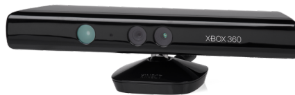
FIGURE 36 – Solution matérielle pour l'acquisition de scène 3D
