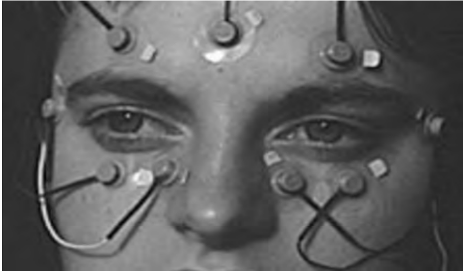
FIGURE 2.8 – Exemple de l'électro-oculographie (EOG) mesurant les mouvements oculaires.
