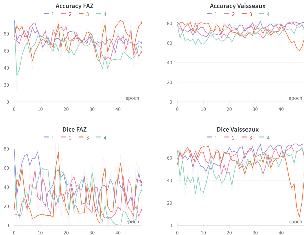
FIGURE 21 – Scores d’accuracy et de Dice sur les vaisseaux et la FAZ sur les 4 modèles testés (50 epochs).
