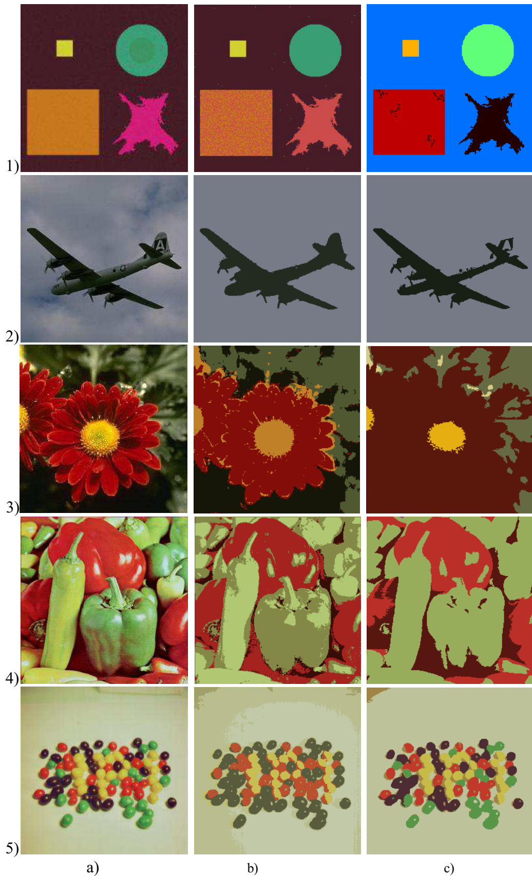
Fig. II.8 : Résultats de la segmentation par l’algorithme EM des images couleur 1) Image "Synthétique" 2) Image "Avion" 3) Image "Fleurs" 4) Image "Peppers" 5) Image "Jelly" a) Images originales b) résultats de la segmentation vectorielle c) Résultats de la segmentation marginale
