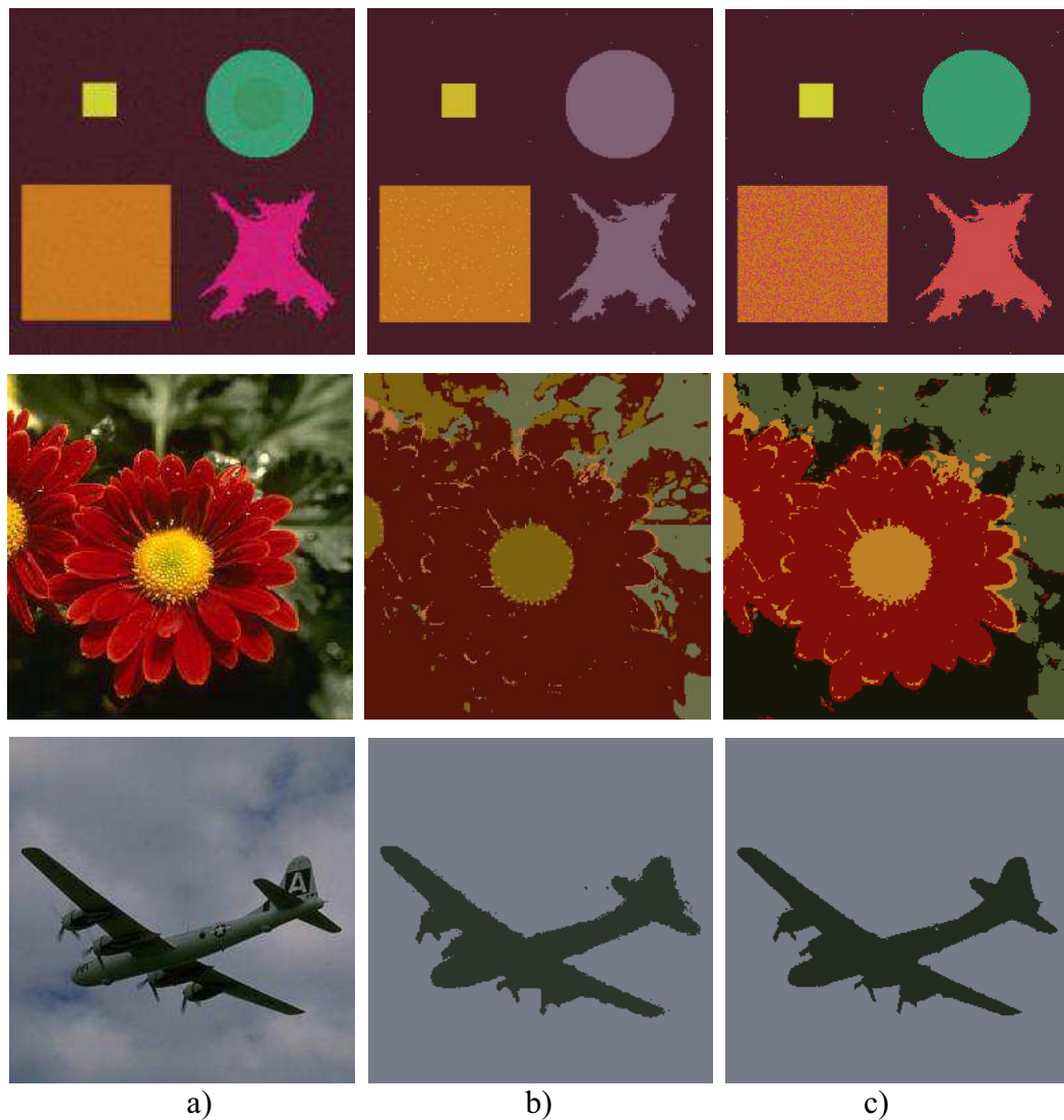
Fig. II.7 : Résultats de la segmentation vectorielle par l'algorithme EM en utilisant une initialisation aléatoire et l'initialisation proposée a) Images originales b) Résultats de la segmentation par EM en utilisant une initialisation aléatoire c) Résultats de la segmentation par EM en utilisant l'initialisation proposée
