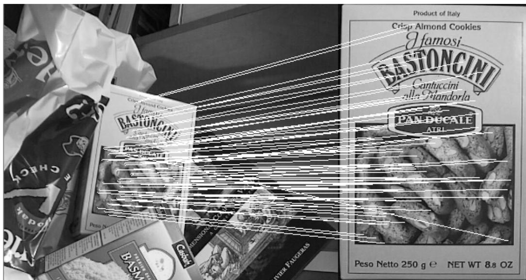
**Figure 5.1 – La recherche d'image par la détection et la mise en correspondance des points d'intérêt SIFT (résultat obtenu par le logiciel SiftDimo<sup>1</sup>).**
