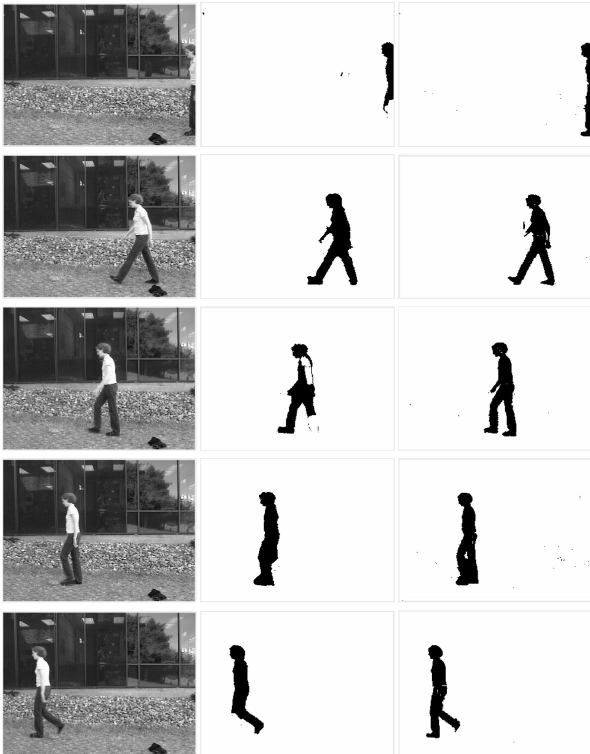
Figure 2.9 – Résultat de détection de mouvement dans la séquence *Walk*. La première colonne contient les images originales. La deuxième colonne contient les résultats obtenus par l'utilisation de la différence entre trois images successives (2.2). La troisième colonne contient les résultats obtenus par l'utilisation de différence entre l'image de référence et l'image  $I_t$ .
