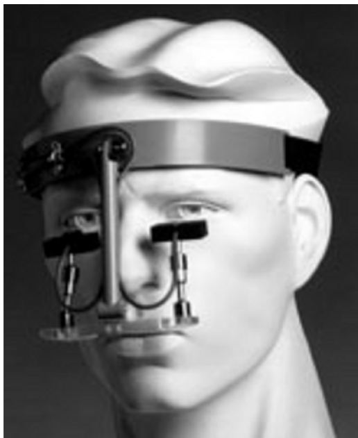
(c) Un autre exemple d'appareil infra rouge de suivi de la limbe porté par sujet. (d) Exemple de "pupille brillante" (et reflet cornéen) illuminée par la lumière infra-rouge.
