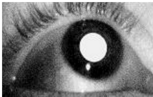
(c) Un autre exemple d'appareil infra rouge de suivi de la limbe porté par sujet. (d) Exemple de "pupille brillante" (et reflet cornéen) illuminée par la lumière infra-rouge.
