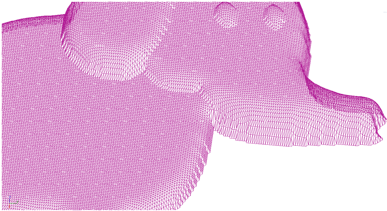
FIGURE 5.20 : Maillage de l'éléphant, nous pouvons observer que les bords de la forme (les sommets à gauche des traits du dessin) ne sont pas lisses
