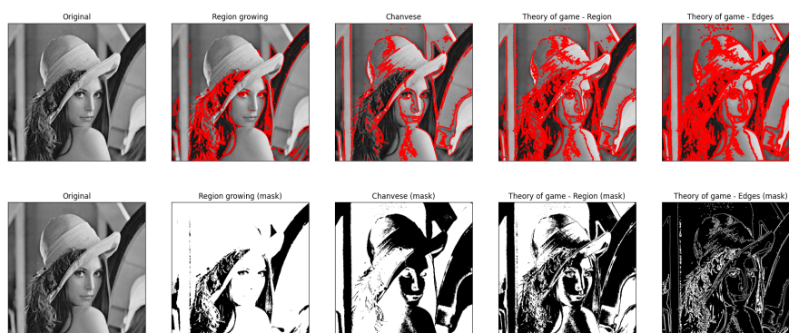
Résultat de notre méthode sur l’image ”lina” Ligne 1 : image original avec le contour Ligne 2 : masque résultant de la méthode associé
