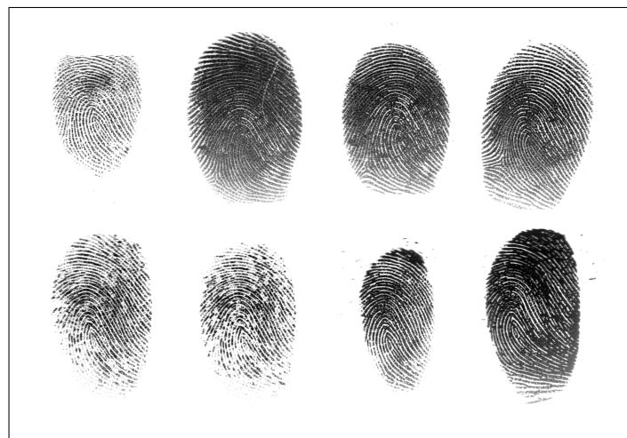
FIG. 2.2: Acquisitions d'une même empreinte avec un capteur "V300" de la société CrossMatch. On peut constater des différences flagrantes qui peuvent nous faire hésiter quant à la similitude entre ces empreintes.
